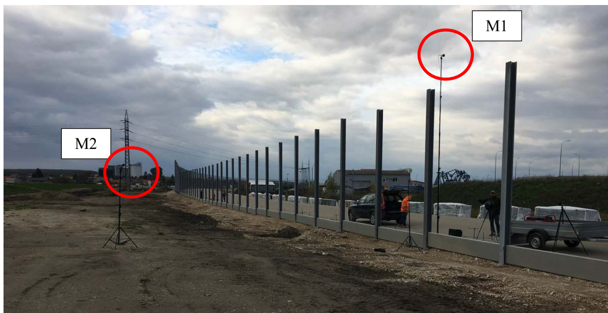
Obr. 3 Fotografia pri meraní bez inštalovanej PHS, poloha M1 a M2
